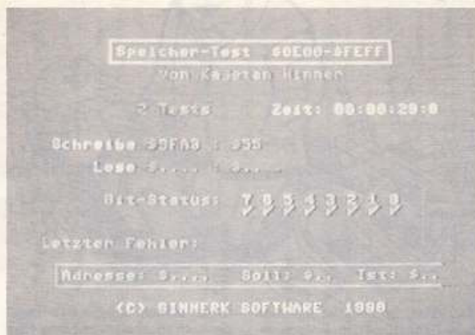
4 Wenn die Speicher-ICs in Ordnung sind, wird hinter der Leseanzeige ein Richtigzeichen eingeblendet (Korrekturhaken)
